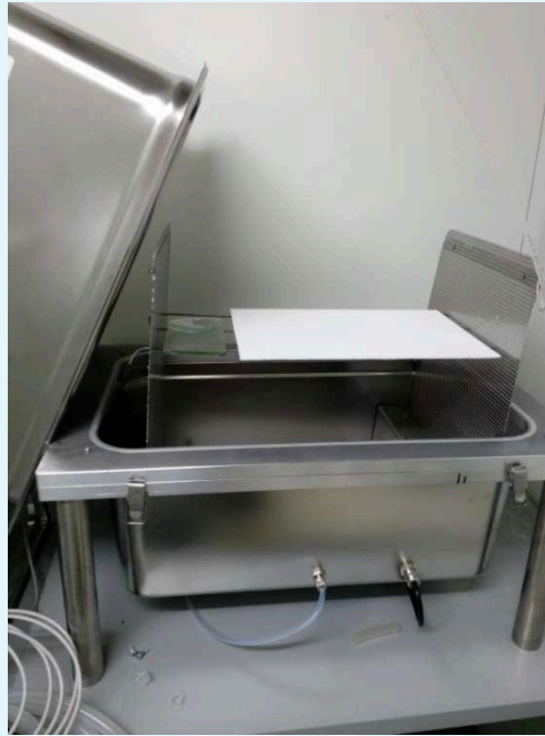
Fotografia della camera aperta con campione e lente di vetro contenente la formaldeide da abbattere.
